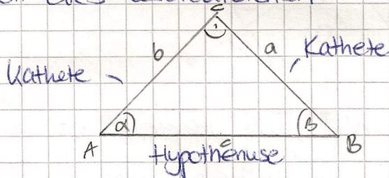
Hierbei ist b die Ankathete zu  $\alpha$  und a die Gegenkathete zu  $\alpha$ . Betrachtet man am Winkel  $\beta$ , so ist b die Gegenkathete und a die Ankathete. Der Winkel  $\gamma$  ist  $90^\circ$ .
