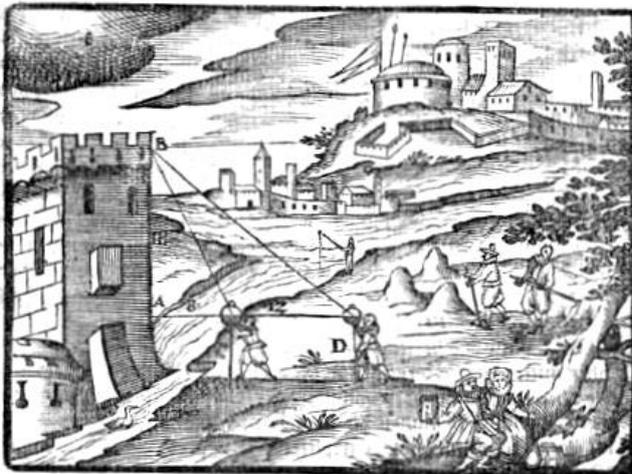
Abb. 5: Bestimmung der Turmhöhe durch Winkelmessung von den Enden einer Standlinie aus, Galgemaier 1616
