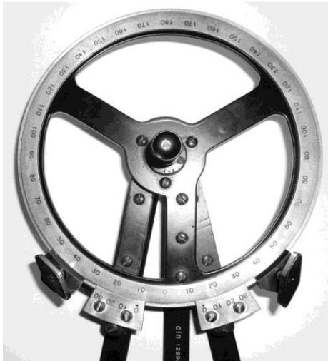
Abb. 7: Feineinstellung mit Noniusskala
