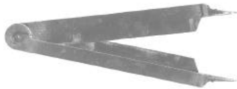
Fig. 37: Frühform eines Proportionalzirkels mit Spitzen; 17. Jahrhundert
