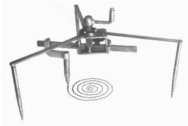
Fig. 63: Spiralzirkel mit „vollständiger“ Spirale
